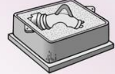
Model çıkarıldıktan sonra alt derece
