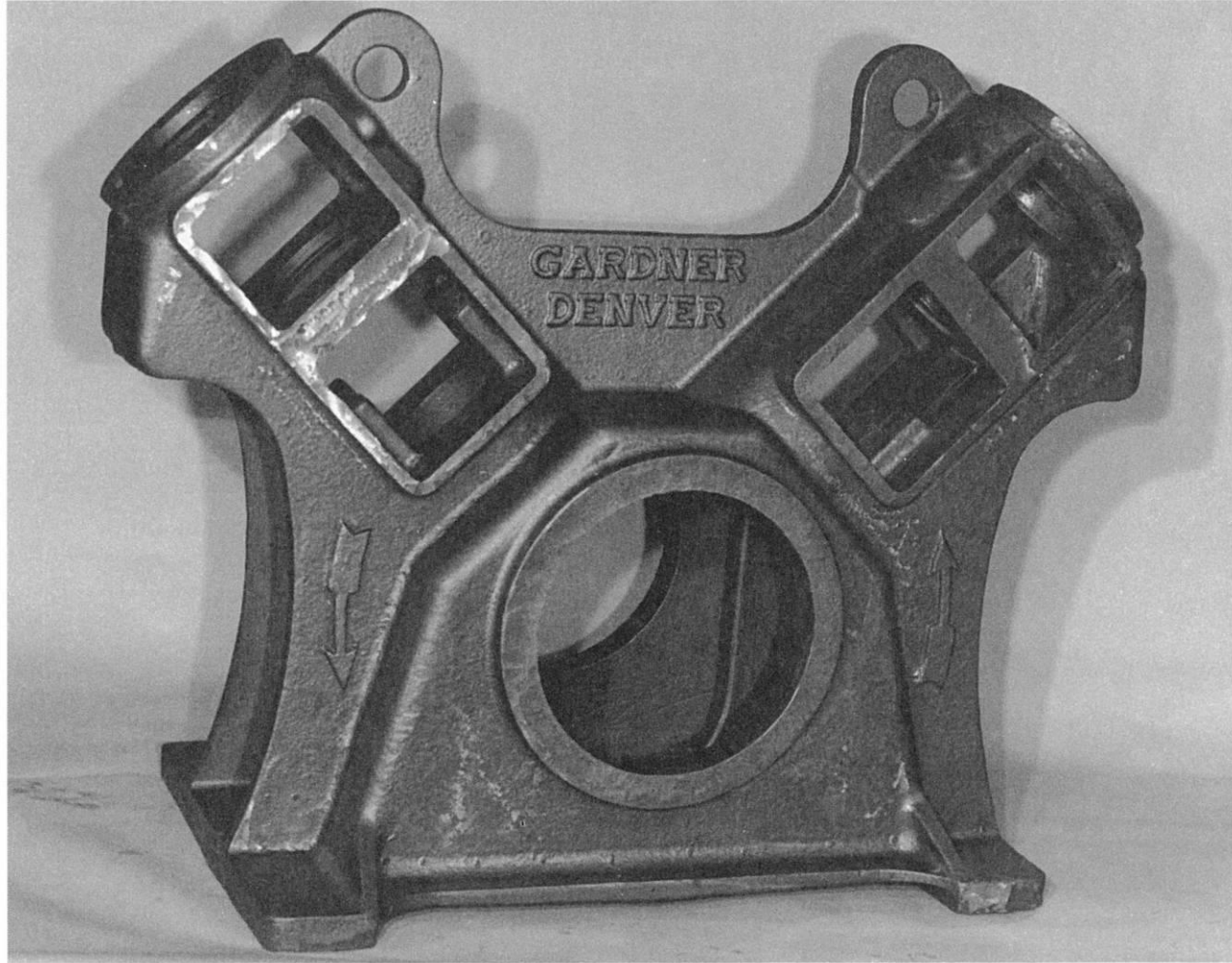
Şekil 11.1 Bir hava kompresörü çerçevesine ait, 680 kg ağırlığındaki büyük bir kum döküm
