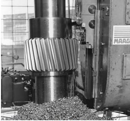
Foto 1.2, Maag metoduyla ve Maag makinasında dış helis dişli üretimi (Maag)
