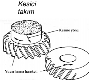
Şekil 1.4, Helis dişli açma
